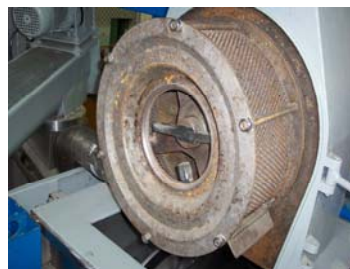
Figura 11.- Interior de un molino de martillos
