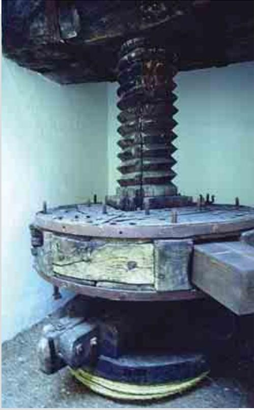
**P**rensar las aceitunas molidas, para obtener de ellas la mayor cantidad del aceite que contiene, siempre resultó un esfuerzo ímprobo hasta que no se aplicaron las nuevas tecnologías. Los primitivos sistemas para separar la parte líquida (aceite y alpechín) de la parte sólida (el orujo), eran puramente manuales: se cogía una especie de saco, se rellenaba con la masa y, por simple torsión ejercida con las manos, se iba extrayendo el preciado líquido.
