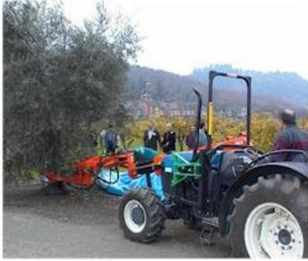
*Vibrador montado en tractor*
