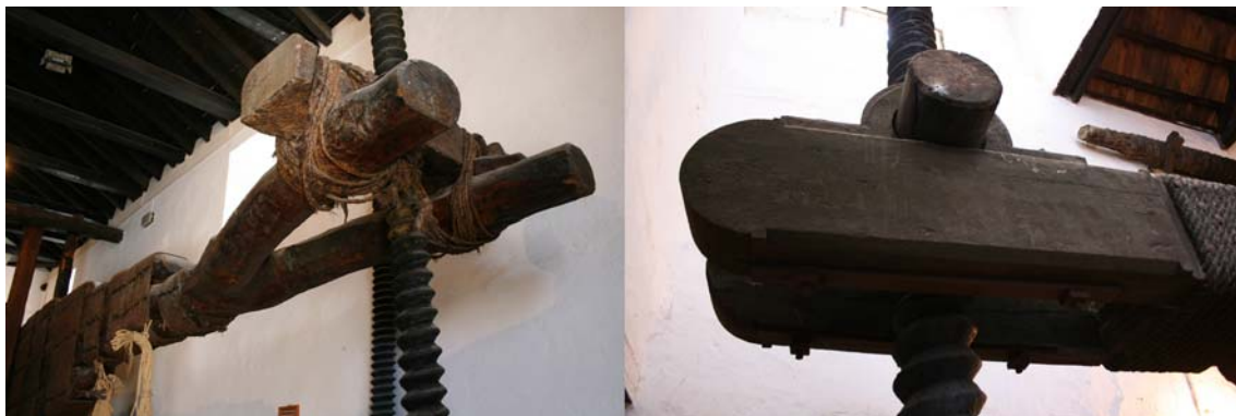
Detalles de prensas: las horquillas de las prensas de viga de la Hacienda “Las Laerillas” (Nigüelas, Granada) y de la Hacienda “Pata de Hierro” (Villanueva del Ariscal, Sevilla)
